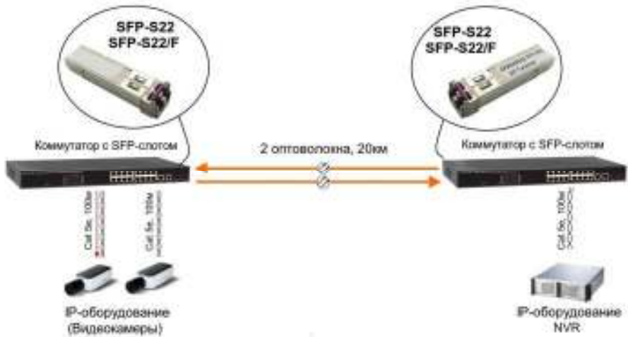
Рис.3 Схема подключения SFP-модулей
