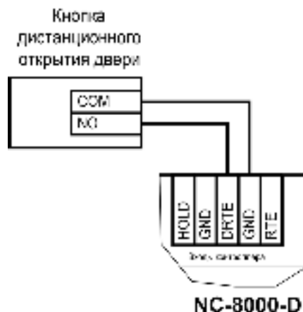
Рисунок 14. Схема подключения кнопки дистанционного открывания двери
