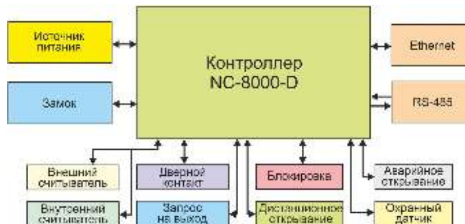
Рисунок 4. Оборудование, подключаемое к контроллеру NC-8000-D
