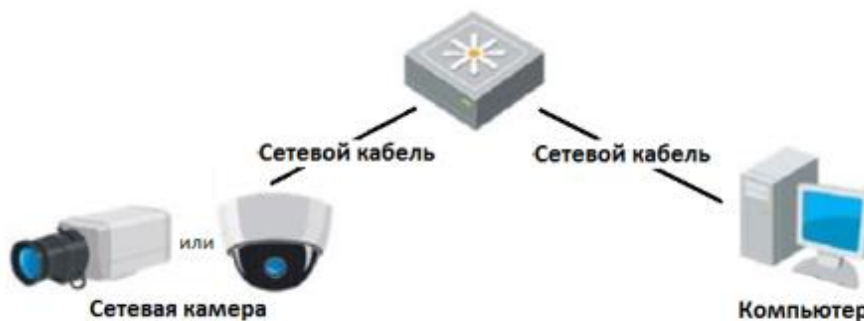
Рисунок 2-2 Подключение через коммутатор или роутер
