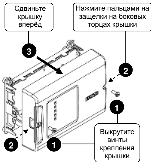
Рисунок 2. Снятие крышки блока
