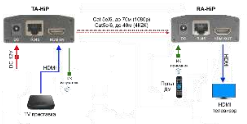
Рис.6 Типовая схема подключения комплекта TA-HiP+RA-HiP
