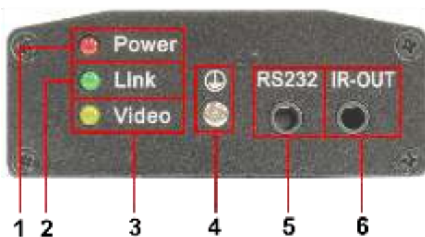
Рис. 2 Передатчик TA-HiP, разъемы и индикаторы на передней панели
