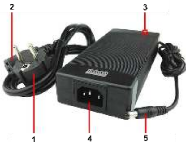
Рис. 2 Блок питания PS-48120, внешний вид, разъемы и индикаторы
