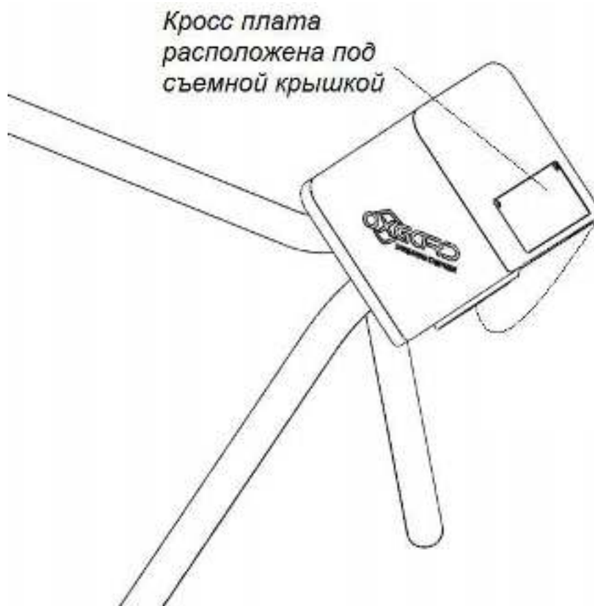
Рис. 9. Расположение кросс-платы на стойке турникета
