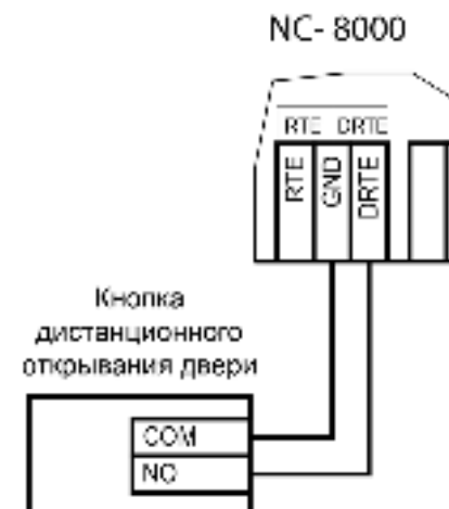
Рисунок 18. Схема подключения кнопки дистанционного открывания двери
