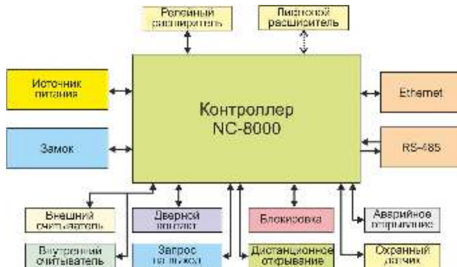
Рисунок 7. Оборудование, подключаемое к контроллеру NC-8000
